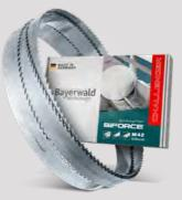
Wenn es in der Metall-Zerspanung auf Standzeit ankommt, führt kein Weg am M42 Bimetall vorbei. Die daraus gefertigten Sägebänder schneiden nicht nur Aluminium und andere Nichteisen-Metalle, sondern schaffen es auch durch Baustähle und legierte Stahlsorten bis hin zum Edelstahl. 8% Kobalt im HSS-Streifen der Zahnspitzen macht die Zähne noch widerstandsfähiger gegen Belastungen und Hitze.
