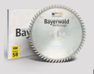
Der negative Spanwinkel verhindert ein selbständiges hereinziehen des Blattes. Somit liefert das Kreissägeblatt mehr Sicherheit und eine bessere Kontrolle während des Schneidvorgangs. Für den universellen Einsatz in Weich- und Hartholz, Plattenmaterial für Kapp- und Gehrungssägen.
